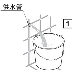
1. 参考尺寸图，铺设供水管路，安装前将铺设好的管路冲洗干净。
