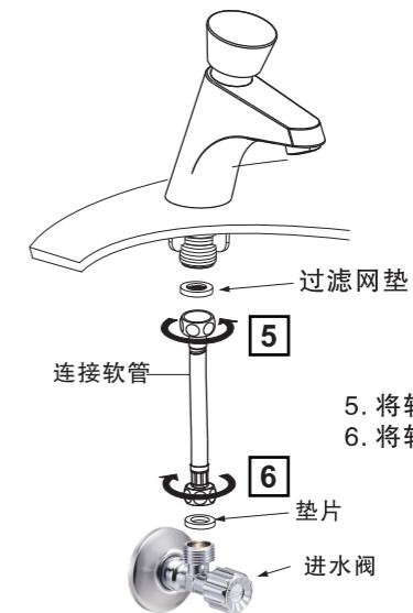
5. 将软管的一端与水嘴的牙管连接
